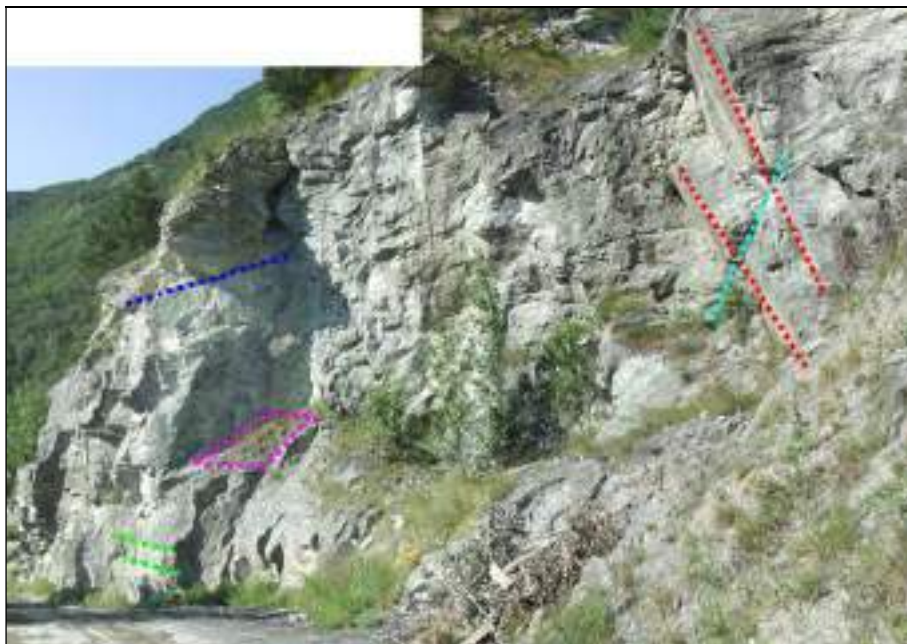
Assetto strutturale: S1 in magenta, K1 in rosso, K2 in azzurro, K3 in verde e K5 in blu
